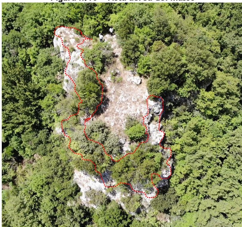
**Figura n.11 - Vista del masso con evidenza dell’orlo instabile**
