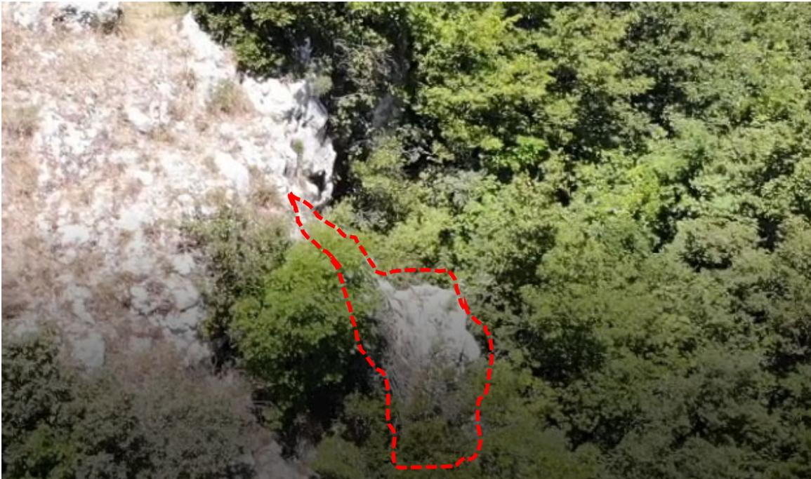
**Figura n.19 - Dettaglio 6 - Blocco detensionato**
