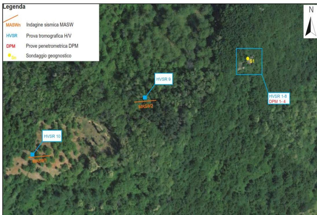
**Figura n.25 - Planimetria con indicazione delle prove**
