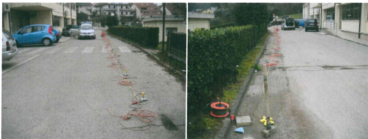
Foto 1 – vista dello stendimento sismico (tipo MASW) realizzato rispettivamente da S e da N (da qui è visibile in primo piano anche il punto di sparso).
