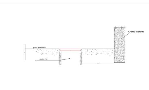
SEZIONE H-H STATO DI PROGETTO
