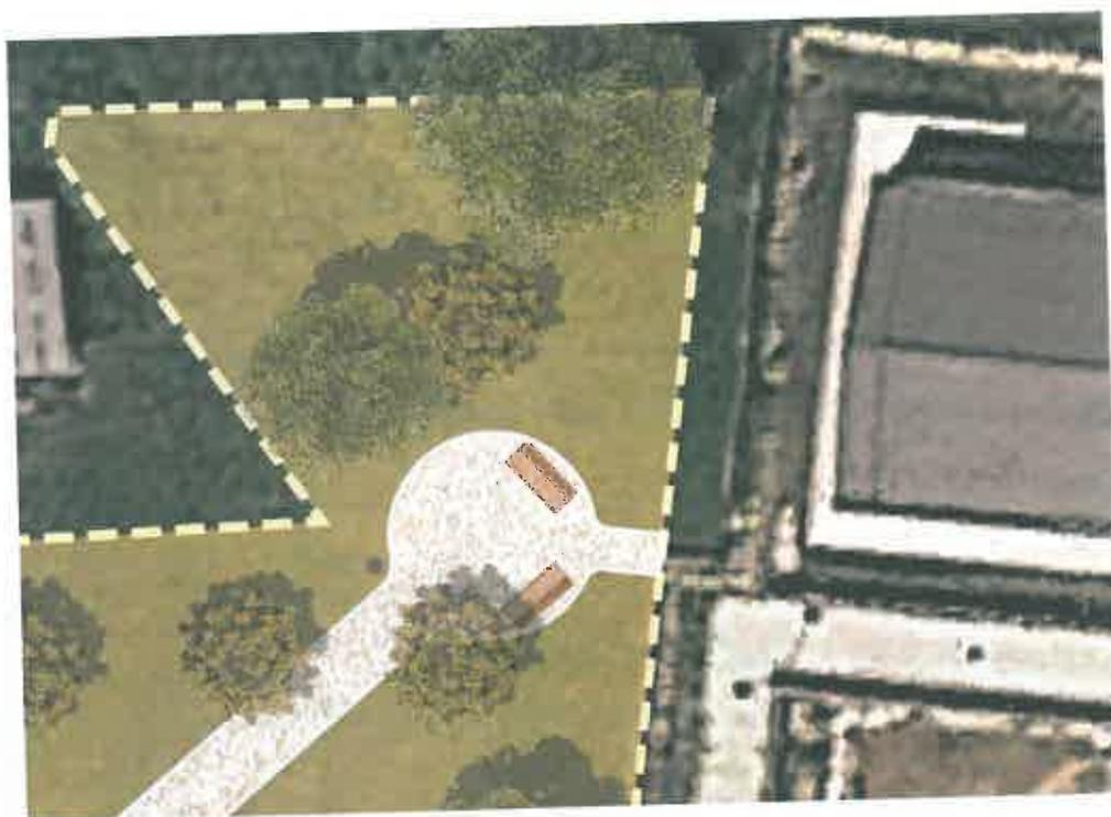
Per il sistema delle piazze e dei percorsi è prevista la posa in opera di pavimentazione permeabile, realizzata mediante posa di uno strato di ghiaietto di 10 cm. di spessore ca.
