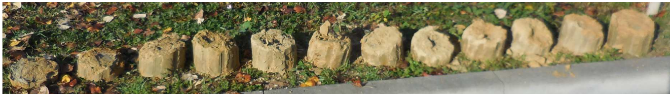
Foto 2. Carote estratte dal sondaggio S1 ad ogni metro di profondità.
