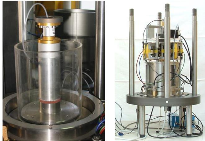
Figura A.1. L'apparecchiatura di taglio torsionale THOR.
