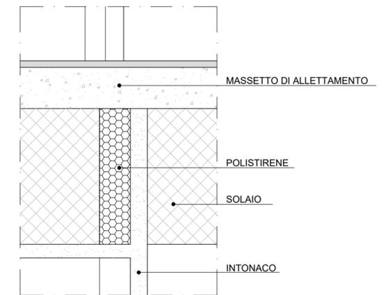
GIUNTO DI STRUTTURA ORIZZONTALE A PAVIMENTO Tipo 2 (S\_2)
