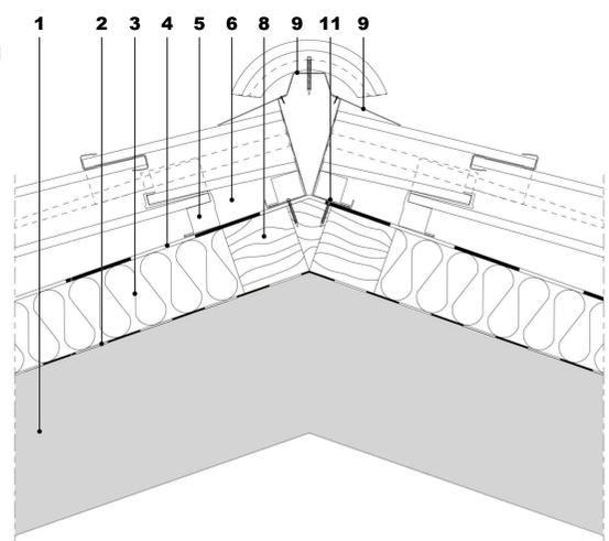
SEZIONE TRASVERSALE SULLA LINEA DI COLMO (COLMO VENTILATO)
