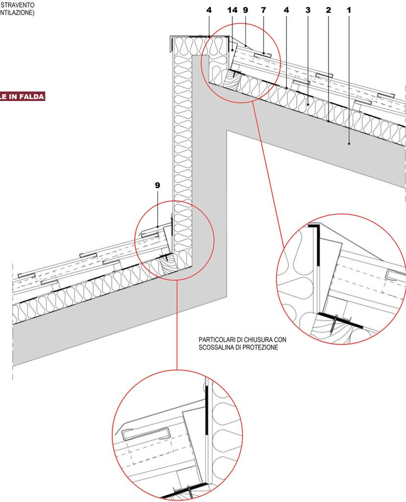
SEZIONE TRASVERSALE COPERTURA A DUE FALDE SFALZATE
