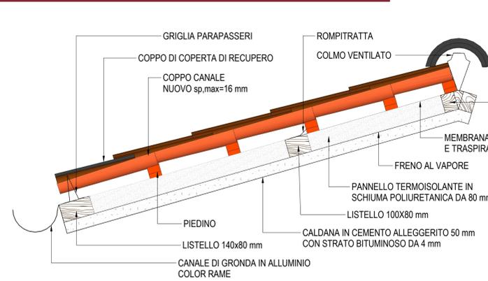
SEZIONE TRASVERSALE FALDA TIPO
