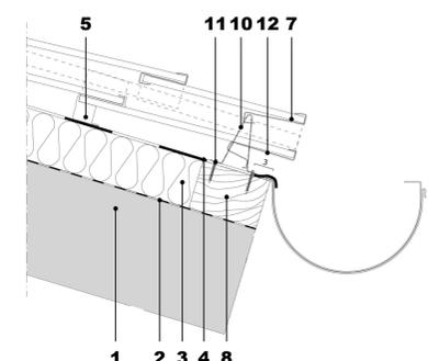
SEZIONE TRASVERSALE SULLA LINEA DI GRONDA
