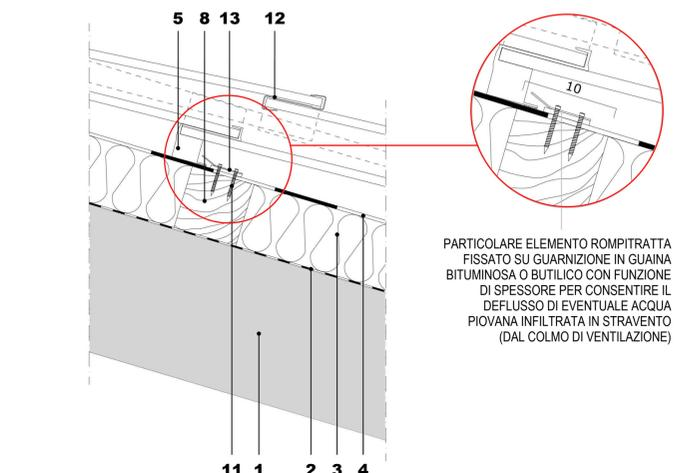
SEZIONE TRASVERSALE IN FALDA
