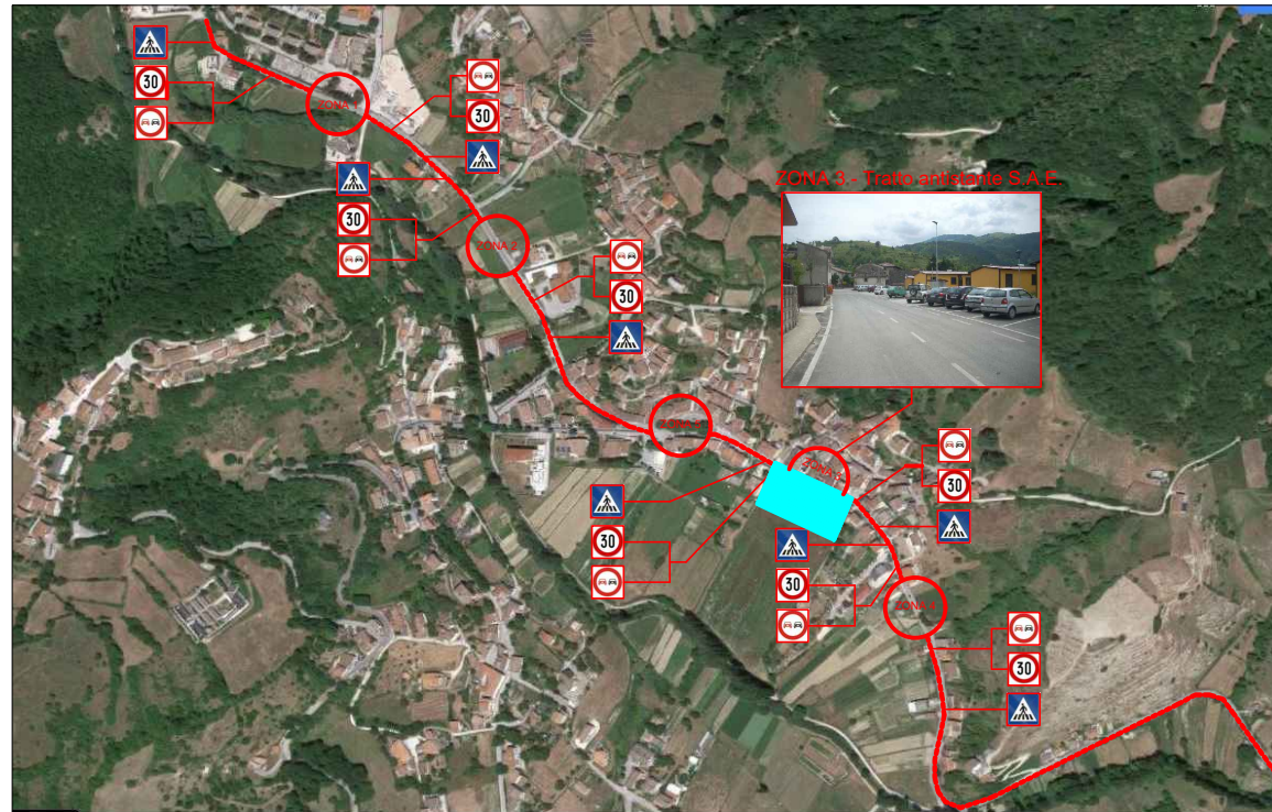
ORTOFOTO CAPOLUOGO- Individuazione punti di predisposizione attraversamenti (con viste) sul tratto stradale della SP 471 Leonessa
