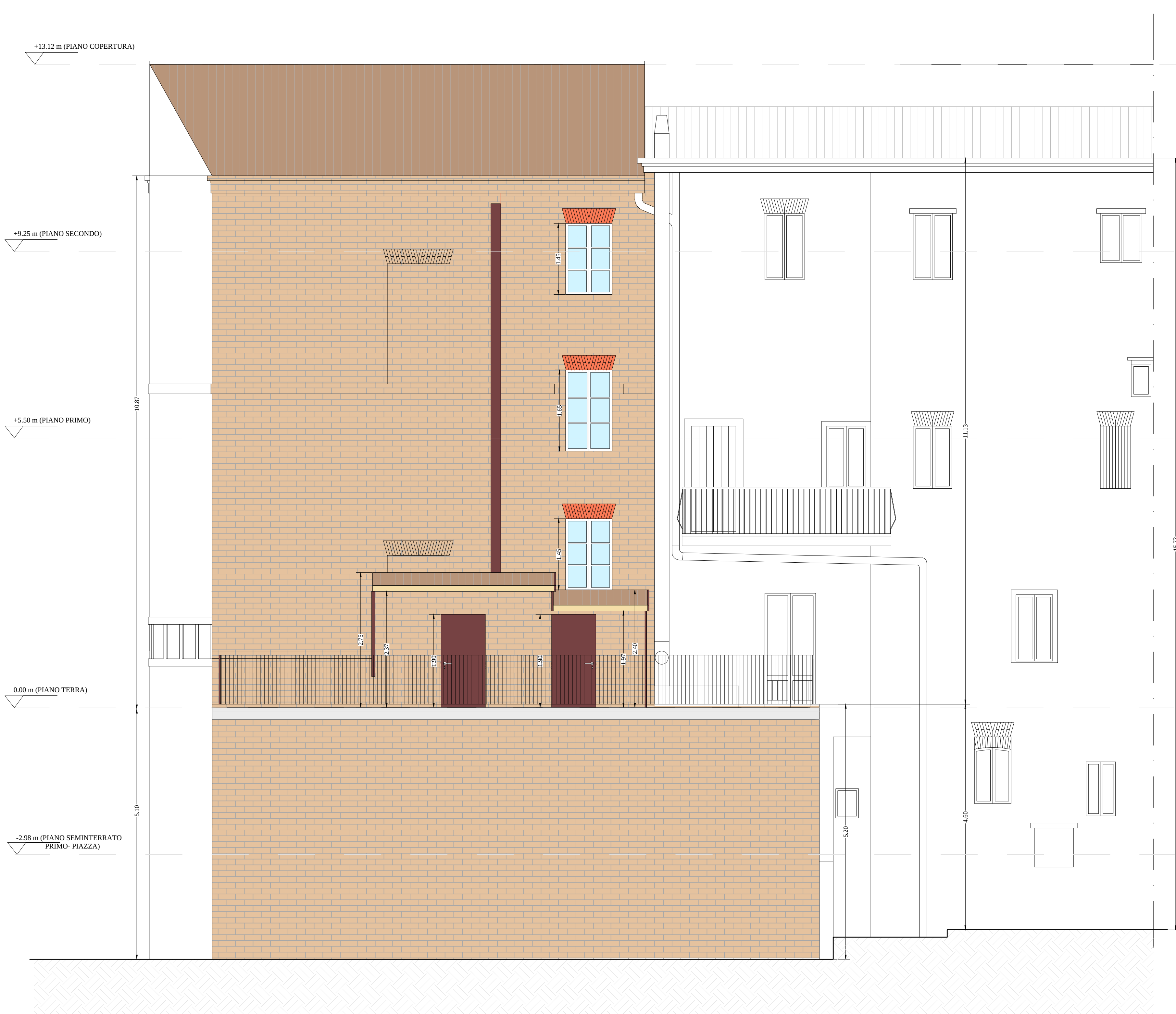
PROSPETTO NORD - SCALA 1:50
