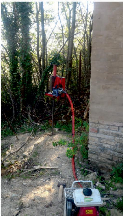
Esecuzione prova penetrometrica n.1
