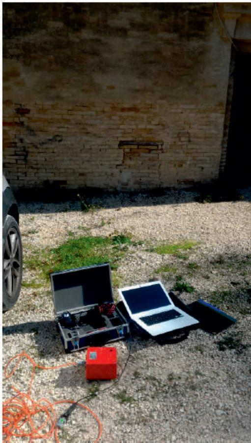
Esecuzione prova Sismica H/V n.1
