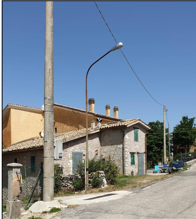
**Foto 11: punto luce su palo da sostituire con lanterna led e palo artistico**
