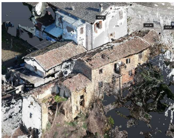
Stralcio rilievo con drone e laser scanner allegati al presente progetto
