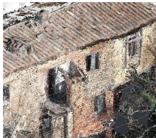
Stralcio rilievo con drone e laser scanner allegati al presente progetto
