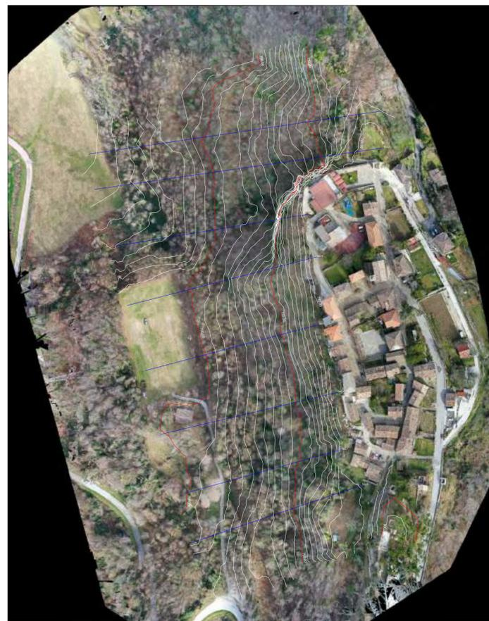
**Rilievo in curve di livello su ortofoto (scala 1:200)**
