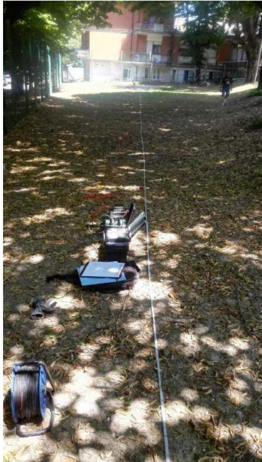
Fig. 1: Stendimento linea sismica per l'acquisizione della MASW
