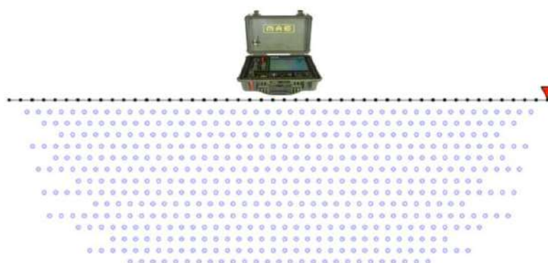
Fig.1.2.1 - Esempio di disposizione spaziale 2D delle combinazioni dei quadripoli di misura.
