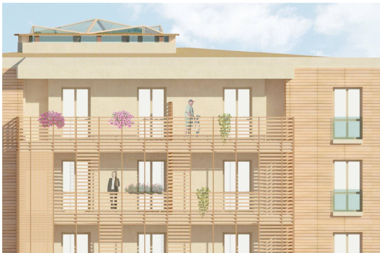
Tipologia del rivestimento di facciata e del contenimento dei balconi, particolare.
