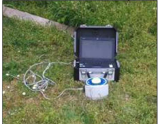
**ANALISI DEI DATI.** Le serie temporali registrate nelle tre componenti del moto vengono analizzate secondo procedure spettrali di vario tipo (FFT, wavelet, ecc.) fino alla produzione delle curve H/V, dove H è la media di due componenti spettrali orizzontali ortogonali. Si rimanda a SESAME (Site EffectS Assessment using Ambient Excitations, 2005) per uno dei possibili esempi di protocollo di analisi.
