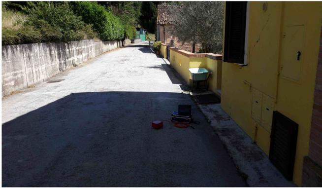
Fig. 3: Terna triassiale in posto per la misurazione.
