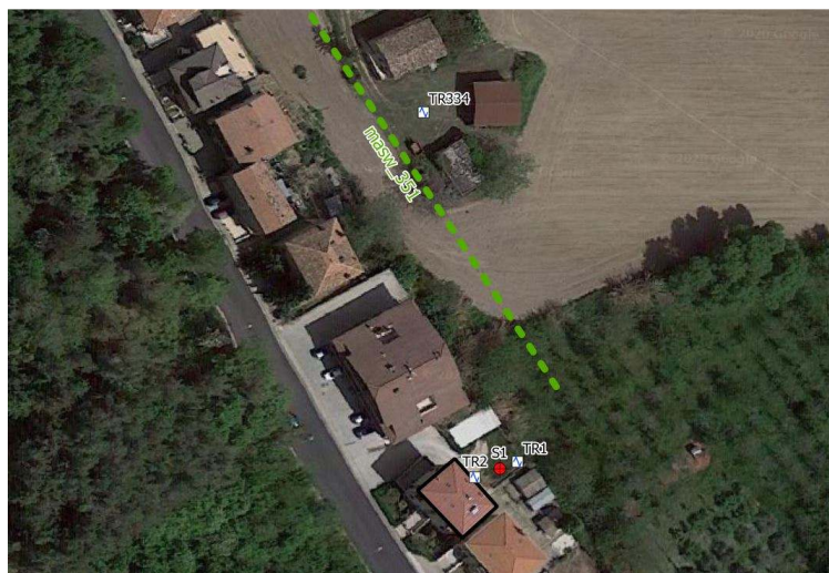
Figura 4 – Planimetria con indicati i punti e i tracciati di indagine; la linea tratteggiata di colore verde rappresenta l'indagine sismica MASW, il simbolo in rosso con le linee interne indica il sondaggio geognostico, il simbolo rettangolare con all'interno una linea spezzata blu indica le indagini sismiche HVSR.
