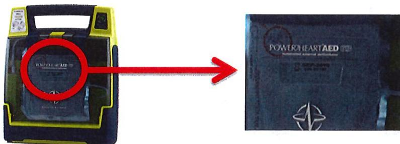
Nel frontale del defibrillatore è posta una finestra dove viene indicata la scadenza degli elettrodi. Gli elettrodi sono monouso e hanno una durata limitata; non devono essere usati dopo la data di scadenza.
