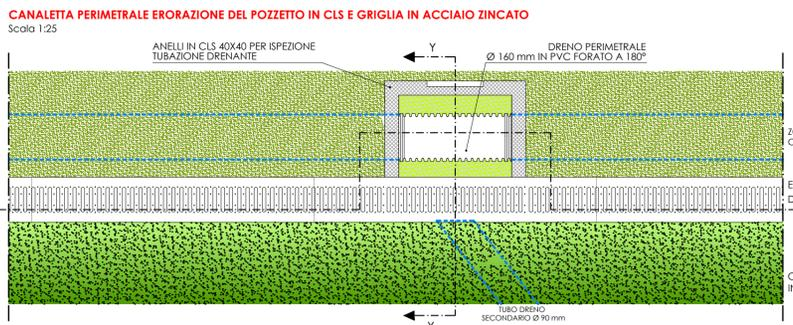
**CANALETTA PERIMETRALE ERORAZIONE DEL POZZETTO IN CLS E GRIGLIA IN ACCIAIO ZINCATO**
