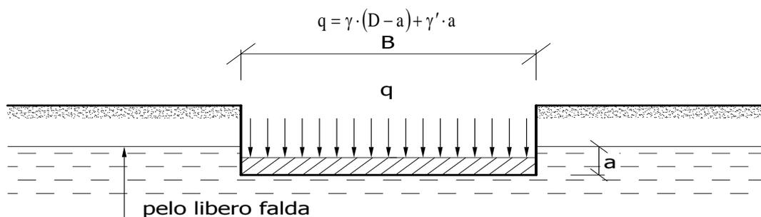
Se il pelo libero della falda è al di sotto del piano di posa della fondazione di una profondità  $d$ , tale che:
