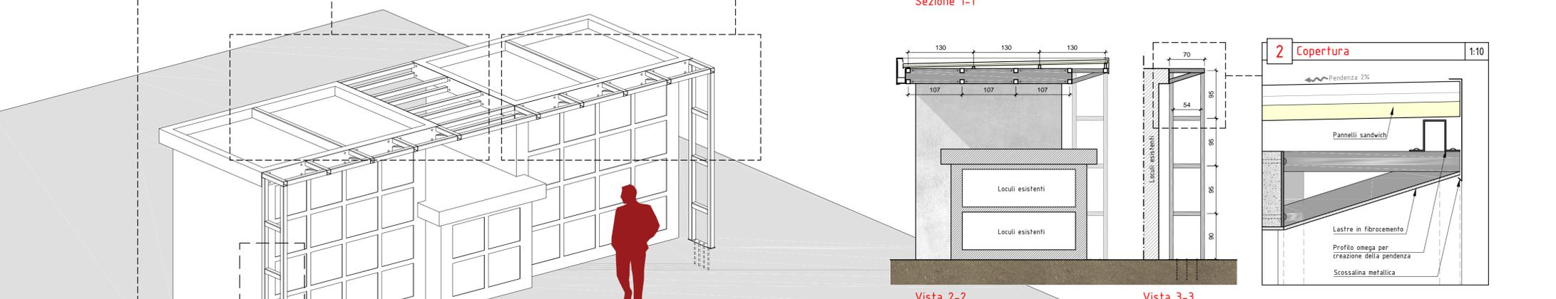
N.B. Tutte le connessioni tra tubolari e tra tubolari e piastre in acciaio, verranno eseguite mediante saldatura sino a completa compenetrazione. Per una corretta realizzazione degli elementi metallici si raccomanda un rilievo di controllo da effettuare in sito.
