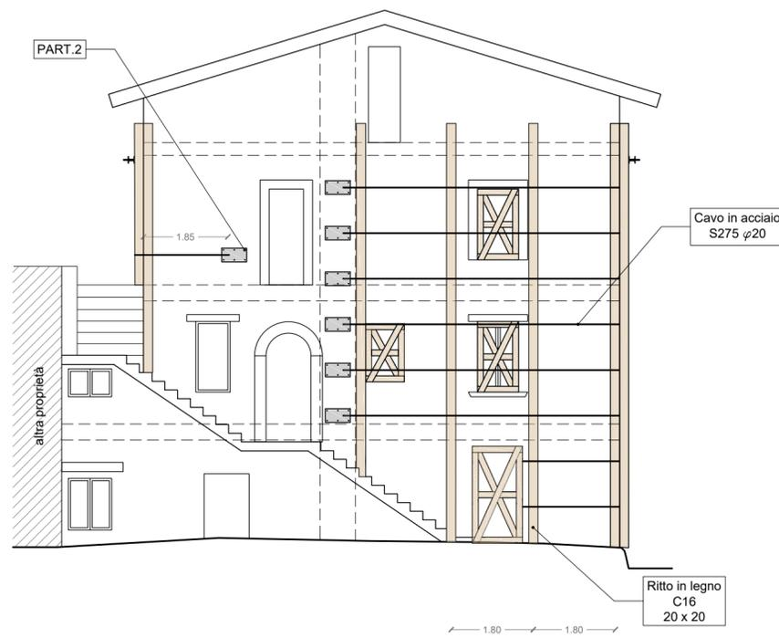
PROSPETTO EST\_ stato di progetto
