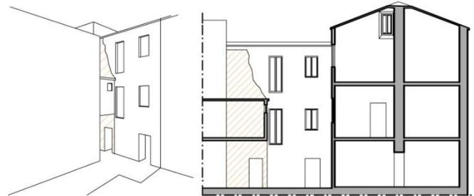
3 Dettaglio: lasciare sperone muro lato ovest e ripristinare impermeabilizzazione e canale di gronda porzione di edificio tra i fabbricati
