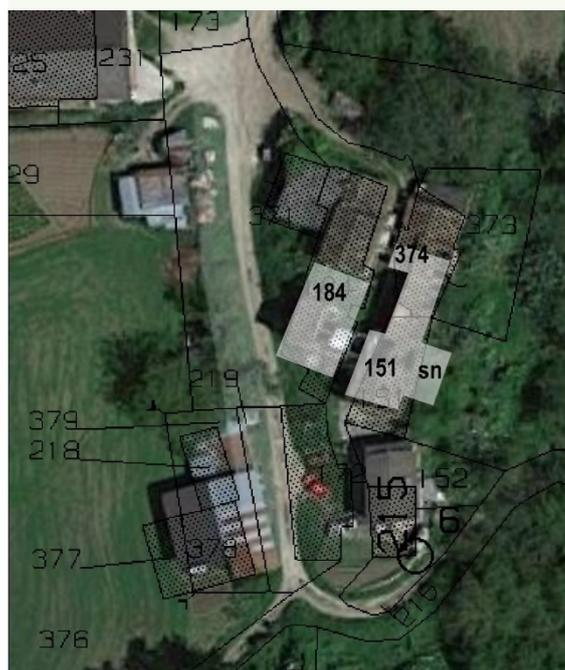
Come da indicazioni della scheda GTS, e alla luce del quadro fessurativo sopra descritto, viene previsto un intervento di demolizione degli aggregati fino ad un'altezza di h 2,00 m da terra (ad esclusione delle porzioni in buono stato individuate nell'immagine sopra, riempimento grigio) che verrà eseguita mediante mezzi.
