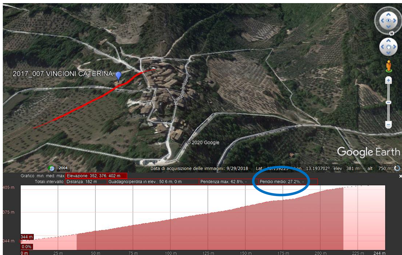
Figura 24 – In rosso, traccia della sezione perpendicolare al pendio e determinazione pendenza.
