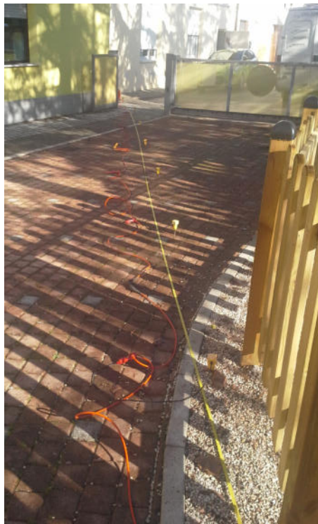
Stesa sismica attiva MASW
