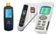
Tutti i misuratori di temperatura senza contatto hanno un raggio luce pilota per un migliore orientamento. I misuratori di temperatura senza contatto misurano solo la temperatura superficiale di superfici visibili, non possono misurare attraverso un vetro. Alcuni modelli hanno un grado di emissione fisso mentre in altri è possibile regolare il grado di emissione a seconda del materiale da misurare (carta, legno, superfici metalliche).
