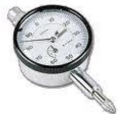
I comparatori normalmente vengono realizzati con corse utili comprese tra 1 e 100 mm, mentre la risoluzione è normalmente centesimale (0,01 mm), anche se vengono realizzati comparatori di precisione bimillesimali (risoluzione 0,002 mm).
