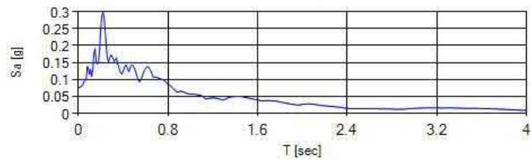
Accelerazione spettrale Output (SLO) - (Condizione19) - (Nodo 32DirezioneX)
