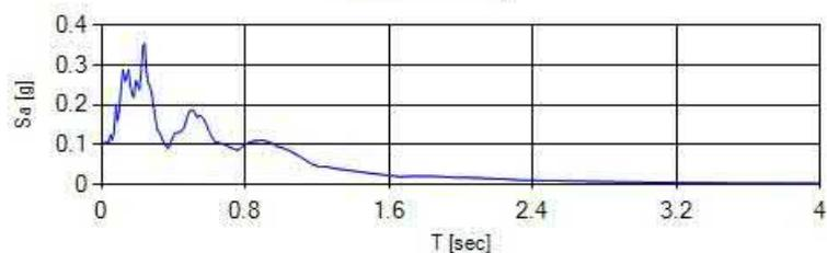
Accelerazione spettrale Output (SLO) - (Condizione18) - (Nodo 32DirezioneX)
