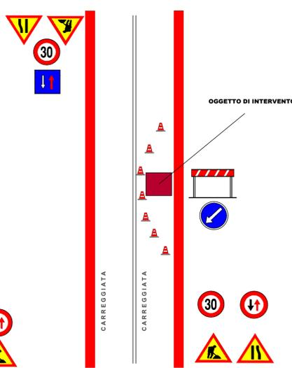
**CANTIERE TIPO CON LUNGHEZZA SUPERIORE AI 50 MT IN PROSSIMITA' DI CURVA STRADALE**
