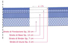
DETTAGLIO SEZIONE STRADALE DI PROGETTO
