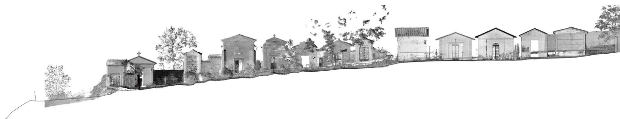
Figura 3: Rilievo laser scanner 3D: prospetto nuvola di punti dell'asse centrale monumentale
