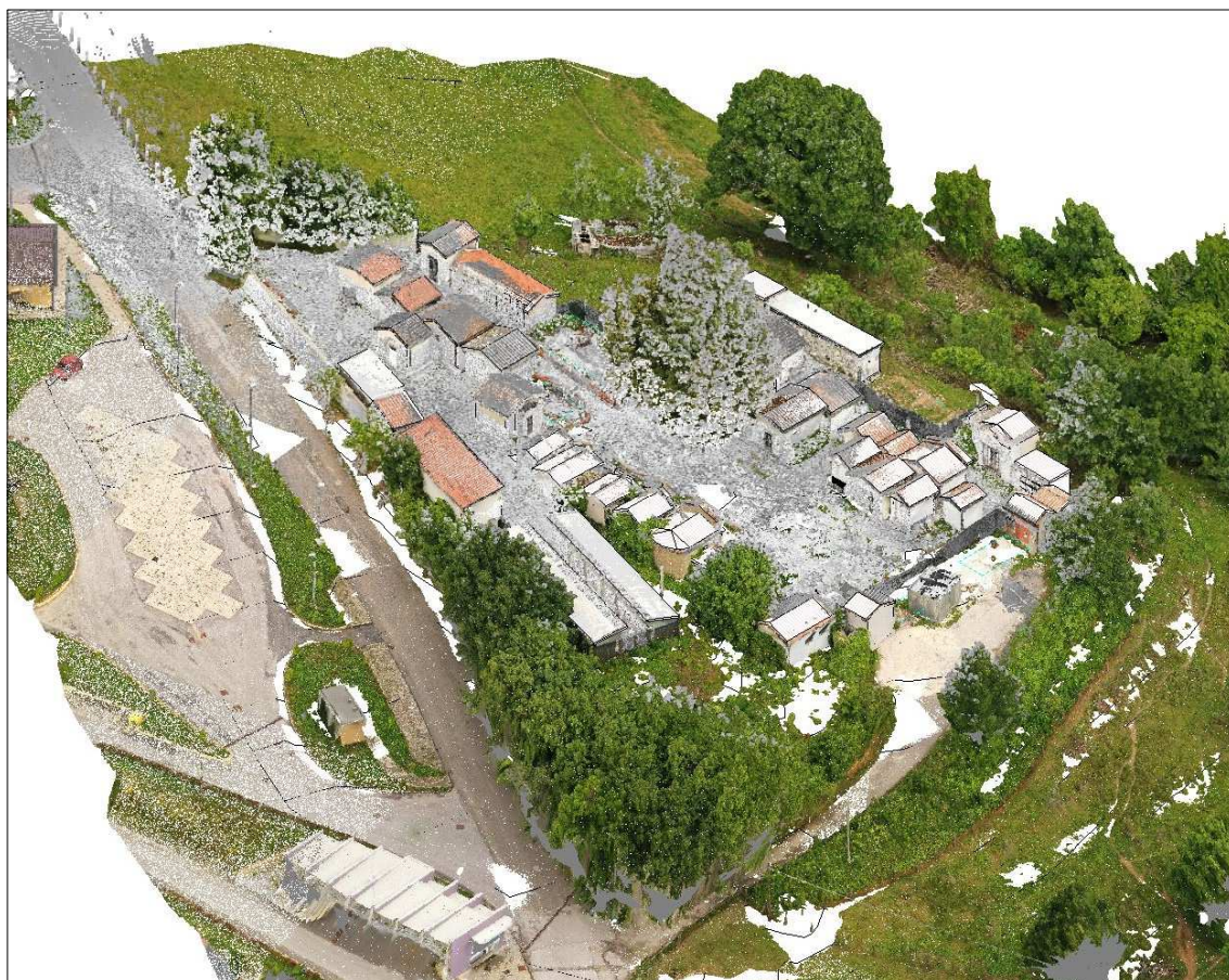
Figura 2: Assonometria BIM tridimensionale con sovrapposizione nuvola di punti Laser Scanner
