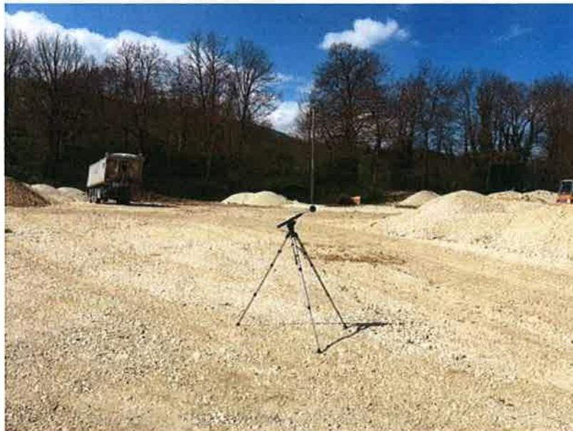
*Figura 4 – Posizionamento del fonometro all'interno dell'area (misura nel periodo diurno)*
