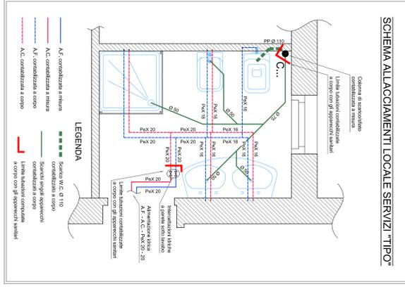
LE TUBAZIONI DI ALIMENTAZIONE IDRICA AI SINGOLI UTILIZZATORI DEVONO ESSERE INTERE - PPA TB - DOVE NON SPECIFICATO DIVERSAMENTE
