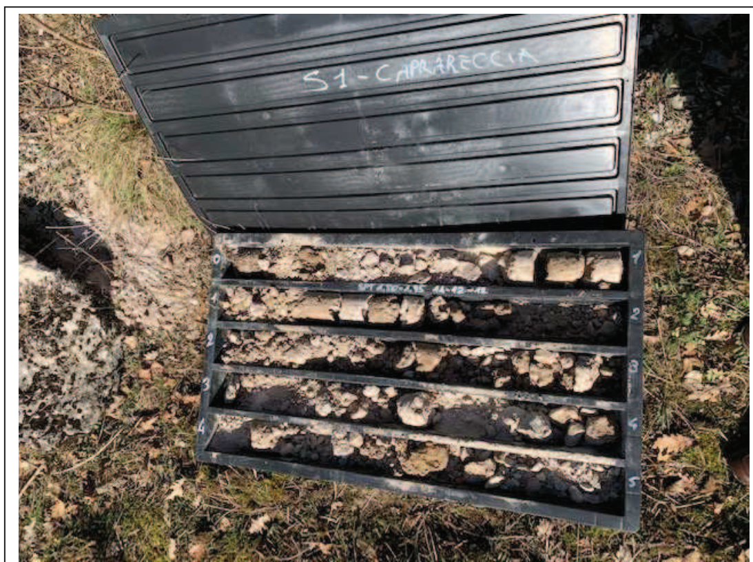
SONDAGGIO S1 - CASSETTA N.1 (0,0-5,0 m)
