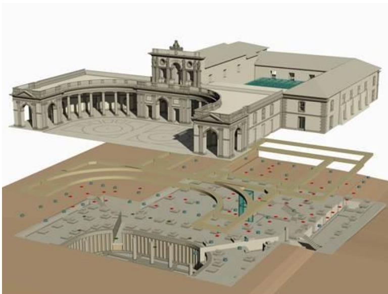
Palazzo dell'Emiciclo a L'Aquila sede del Consiglio Regionale dell'Abruzzo – adeguato sismicamente mediante l'isolamento alla base
