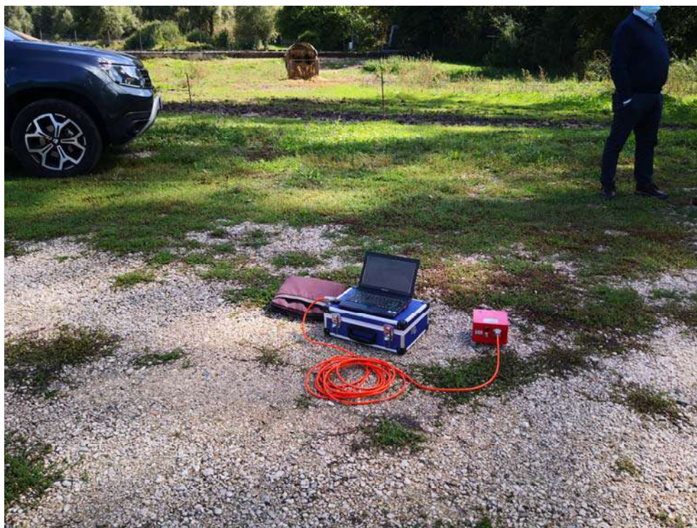
Foto n.4: indagine denominata HVSR
