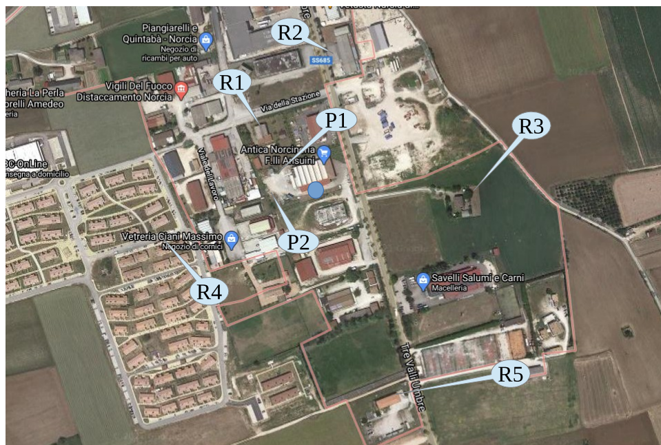
Fig. 6: localizzazione punti di misura(P1-P2) e recettori interessati(R1- R6) alle immissioni sonore
